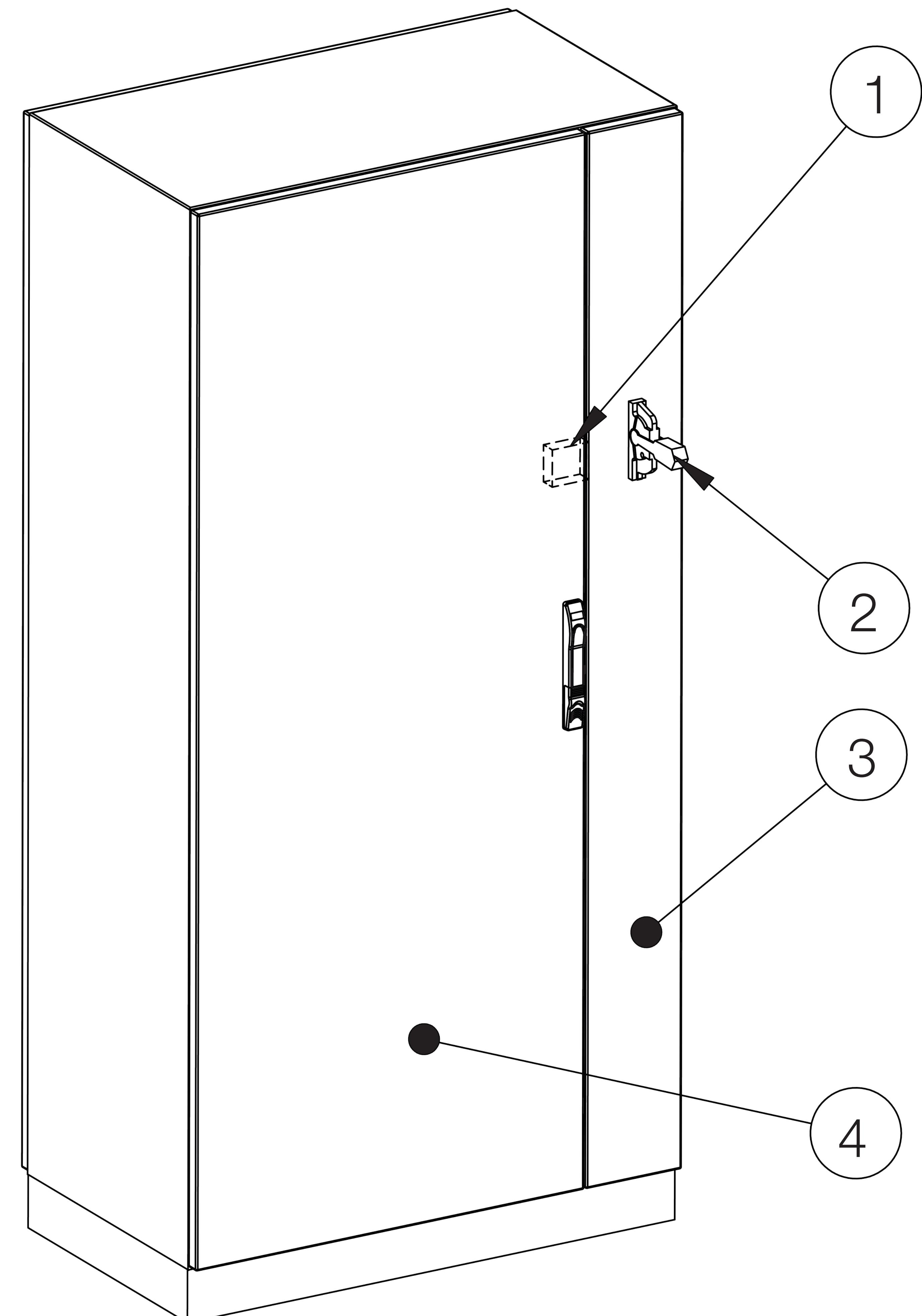
Este tipo de armario normalmente se une a otros módulos en batería y para responder a los requisitos NEM se requiere el uso del kit de enclavamientos que impida la apertura de las puertas de los armarios unidos en batería, si con anterioridad no se abre la puerta prioritaria. Consulte el siguiente esquema para mayores detalles:
