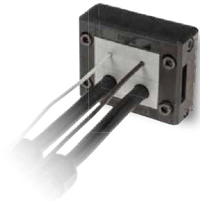
El marco divisible DES Q permite el paso de cables con cabeza con secciones de 2 a 34 mm gracias a los distintos soportes pasacables disponibles. El cierre lateral del marco proporciona protección contra el desgarro y el agua.
